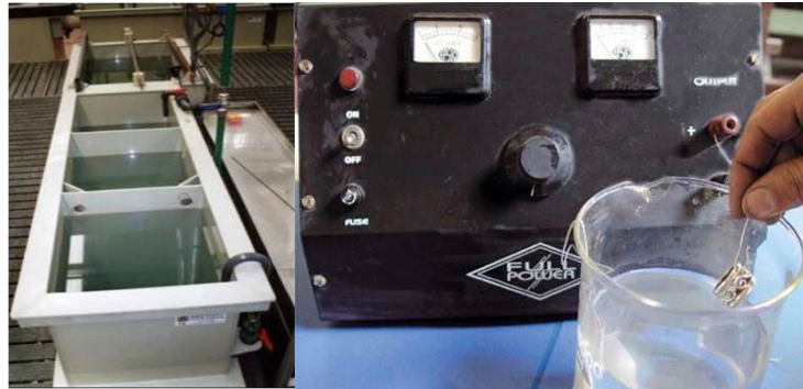
Figura 8. Desengrase de piezas para electropulido a) Lavado con disolventes orgánicos y b) Tratamiento electrolítico de desengrase con baño 7
