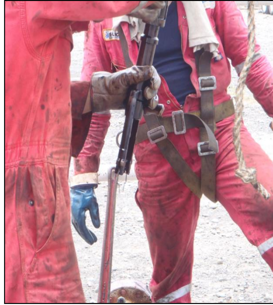
Figura. 4.26 Representa el armado, activación del MPFV y comprobación de cuello de pesca con pescante tipo JDC.
