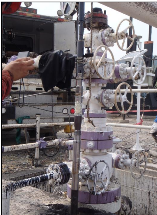
Figura 4.27 Representa el acoplamiento del MPFV a sarta de Línea de Acero.
