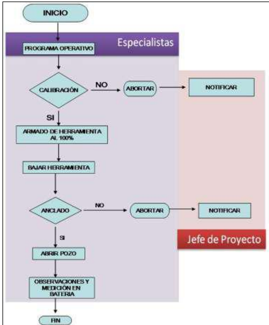
Figura 4.25 Diagrama de flujo para la instalación del MPFV en campo.
