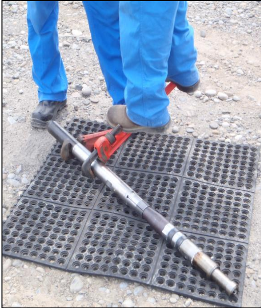
Figura. 4.26 Representa el armado, activación del MPFV y comprobación de cuello de pesca con pescante tipo JDC.
