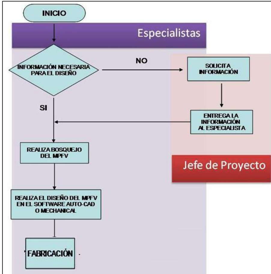
Figura 4.18 Diagrama de flujo para el diseño del MPFV.
