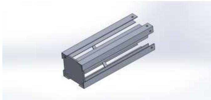
Figura 25.- Estructura externa y parte que sujeta la parte central ensambladas.
