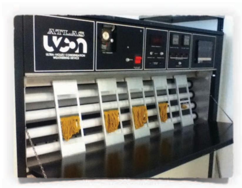
Imagen 18. Cámara de envejecimiento controlado con muestras de fibra teñida. Por Tania Soto.
