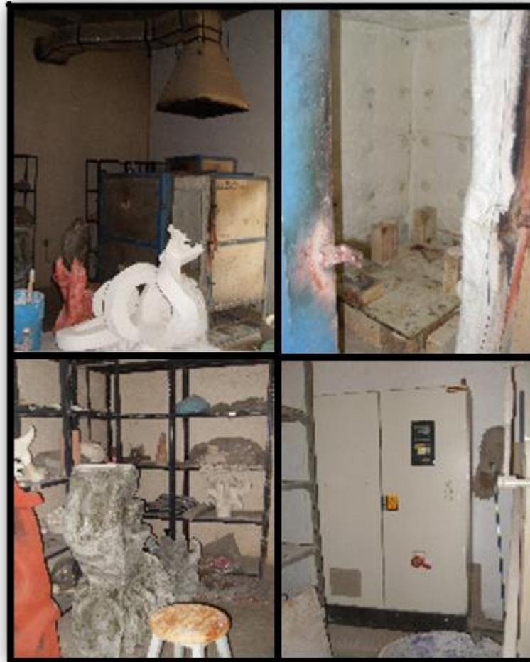
En el **taller de escultura con cerámica** se tienen estos hornos, los cuales dos son eléctricos y uno es de gas LP. Un horno eléctrico puede alcanzar los un mil cien grados centígrados y otro hasta 1400°C, mientras que el de combustión o gas LP, llega a los 1280°C. Dentro del taller de utiliza un torno, mesa de amasado y placas para absorber la humedad.
