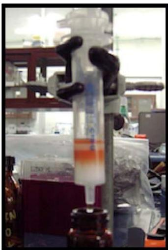
**Figura 24** – Cartucho C18U para cromatografía en fase sólida
