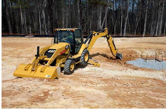
**Fig. 3.8 Retroexcavadora CAT 430F.**
