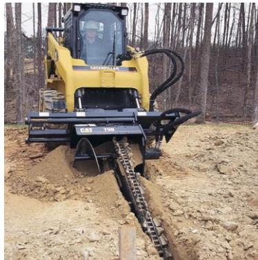
**Fig. 3.10 Excavadora de zanjas CAT T9B.**
