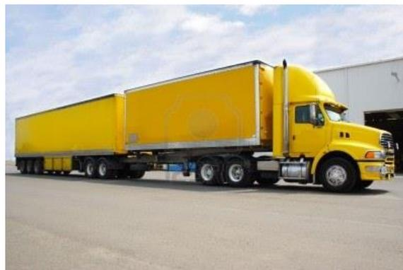
**Fig.3.17 Tractocamión con semirremolque y remolque.**
