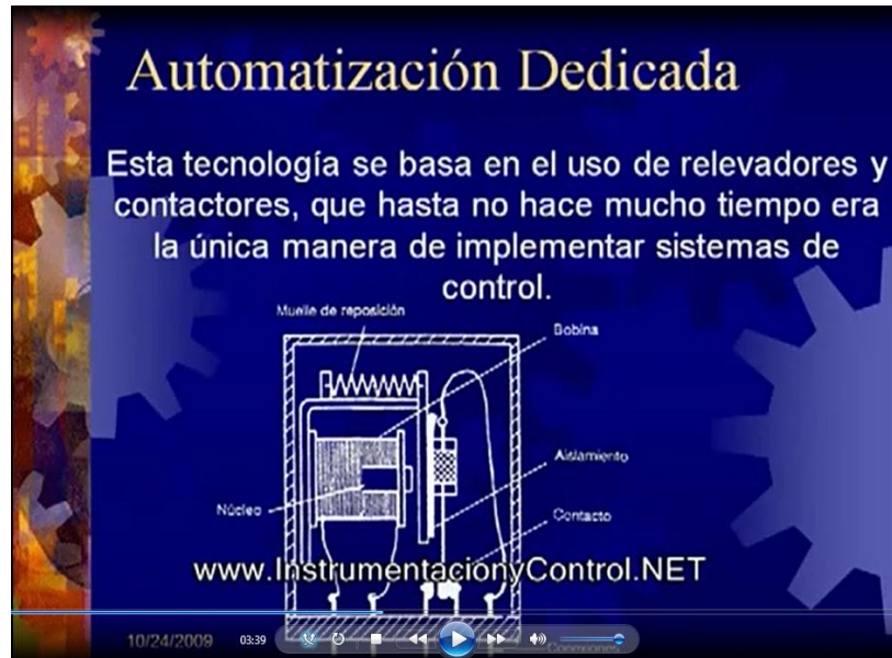
Fig 2.7 Fotografía de la estructura de un relevador.
