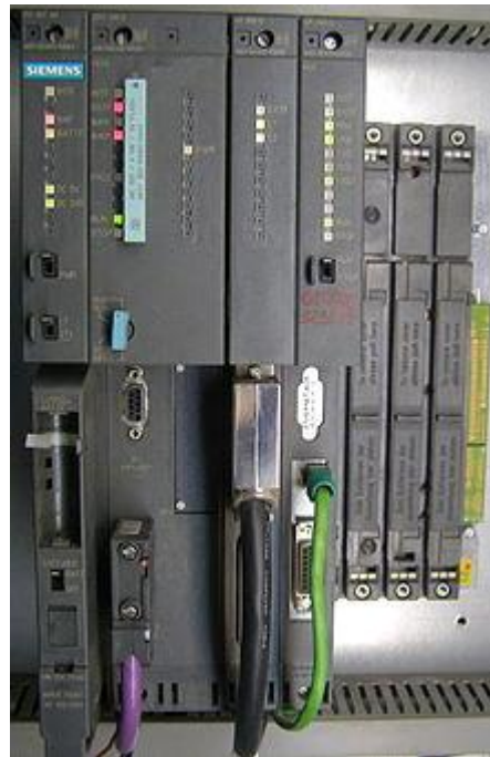
Fig 1.1 UR2 de 9 ranuras, de izquierda a derecha: fuente de alimentación PS407 4A, CPU 416-3, módulo de interfaz IM 460-0 y procesador de comunicaciones CP 443-1.
