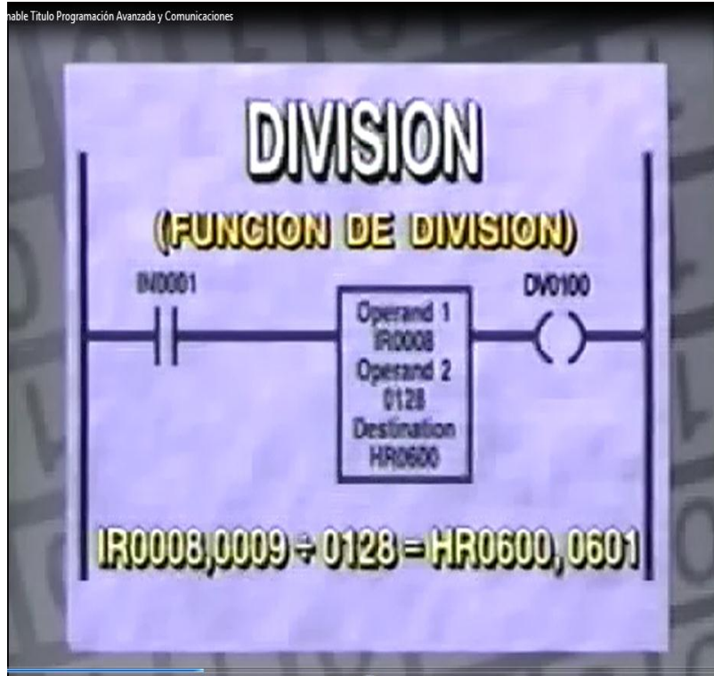
Fig 5.11 función de división del PLC.
