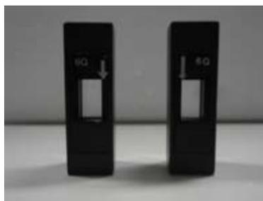
**Figura 5.2.** Celdas de cuarzo de 2mm de paso óptico.
