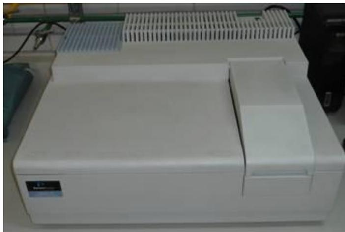
**FIGURA 5.1** Espectrofotómetro UV-Vis Perkin Elmer, Lambda 35 de doble haz.
