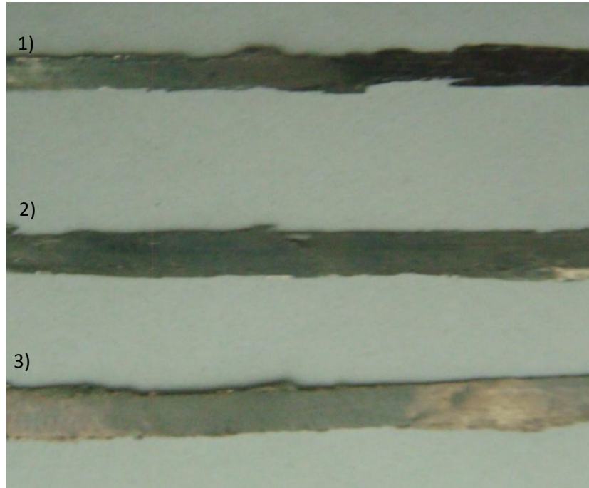
Figura 4-5 Muestra macroscópica de las tres cintas metálicas obtenidas; la cinta 3 se ubica en la parte inferior.
