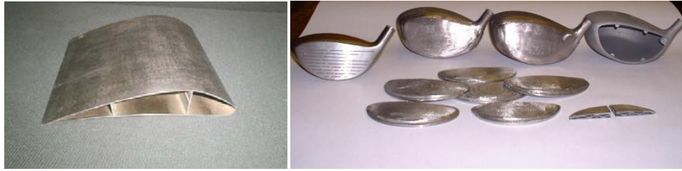
Figura 2-8 Algunas de la piezas obtenidas en el IMSP, en Rusia, a) ala de un avión BT6 fabricada en titanio; b) punteros de palos de golf.
