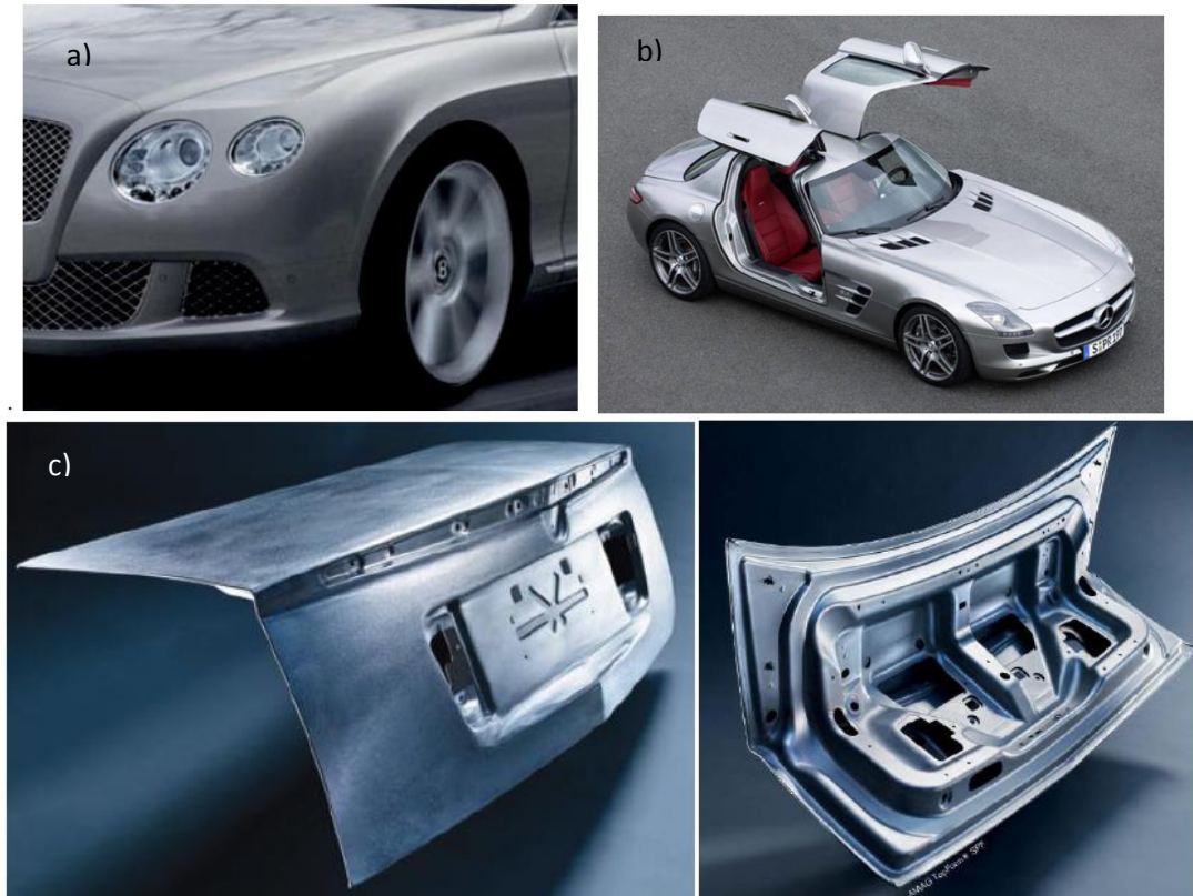
Figura 2-9 a) salpicadera de un modelo de la marca Bentley, fabricado con la aleación AMAG TopForm SPF (AlMgMn); la misma aleación es utilizada para fabricar las puertas abatibles del Mercedes Benz; c) cajuela fabricada para Cadillac STS [29].
