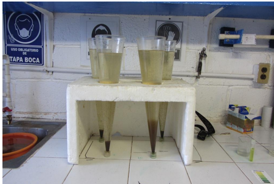
Imagen 4. Conos Imhoff® para medición del volumen de biofloc.
