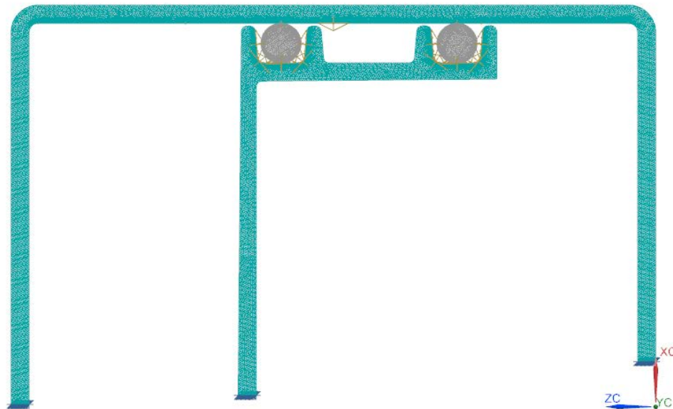
Figura 13. Modelo discreto del conjunto camisa, o-ring y émbolo.
