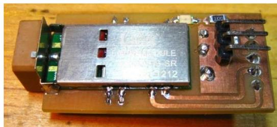
Figura 2.10 Receptor GPS integrado al CanSat.
