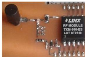
Figura 2.2 Circuito transmisor con antena.
