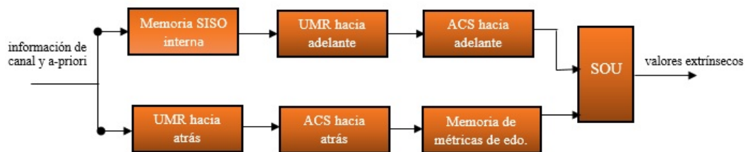
Figura 5.4: Arquitectura SISO con el planificador Backward-Forward .
