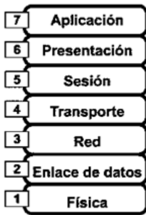
Fig 2. 2 Capas del modelo OSI
