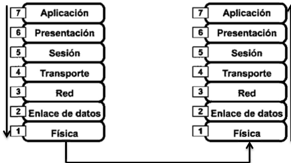
Fig. 2. 3 Forma de enlace de datos entre dos dispositivos mediante el modelo OSI
