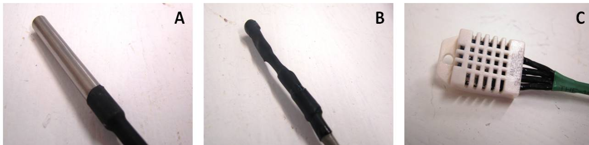
Figura 8. a) Sensor sumergible de temperatura DS18B20 con recubrimiento de acero inoxidable. b) Sensor de temperatura DS18B20. c) Sensor de humedad relativa DHT22.
