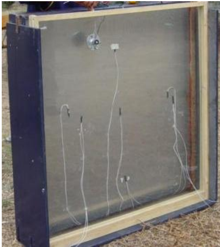
Figura 3.3. Prototipo de Sistema de Descarga de Calor
