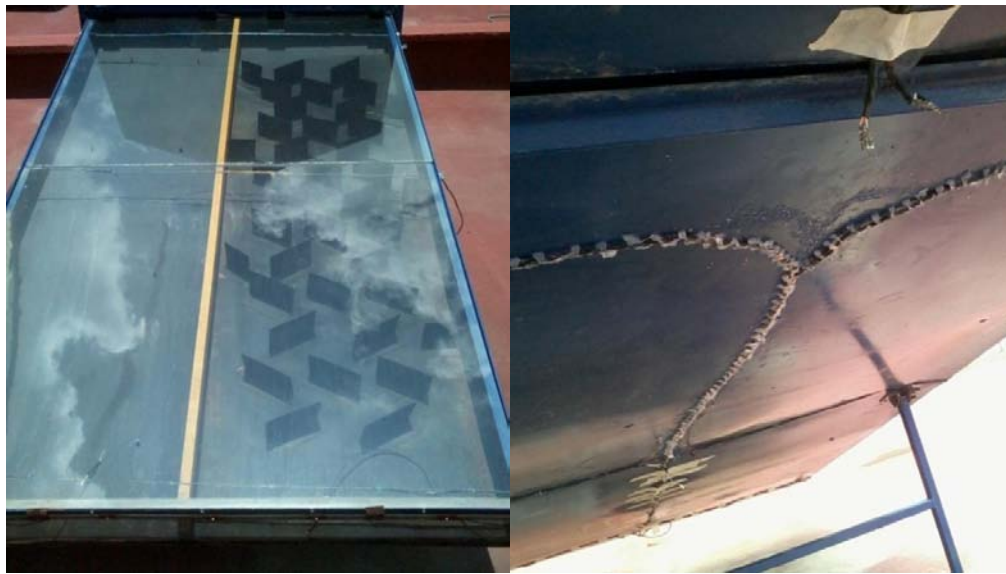
Figura 3.23. Parte anterior y posterior de la placa colectora
