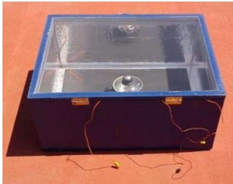
Figura 3.26. Horno solar terminado en etapa de pruebas
