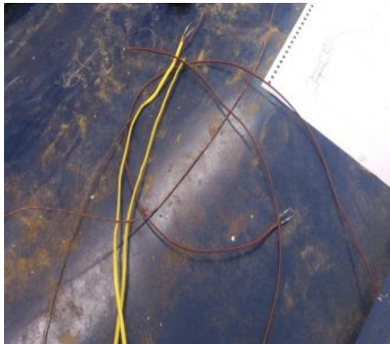
Figura 3.10. Termopares tipo K y tipo J utilizados en los calentadores
