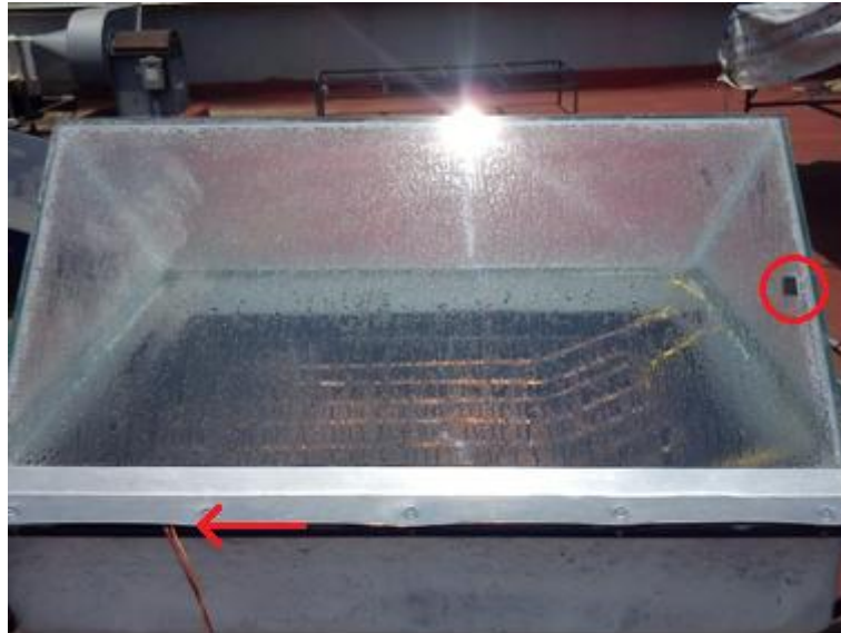
Figura 3.31. Medición de temperatura del agua y del ambiente interno
