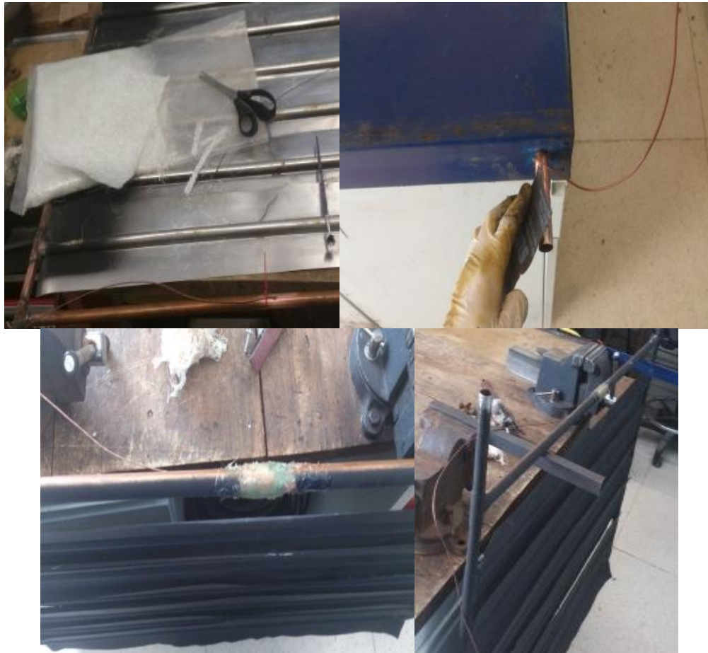
Figura 3.13. Fijación y sellado de termopares con fibra de vidrio y resina
