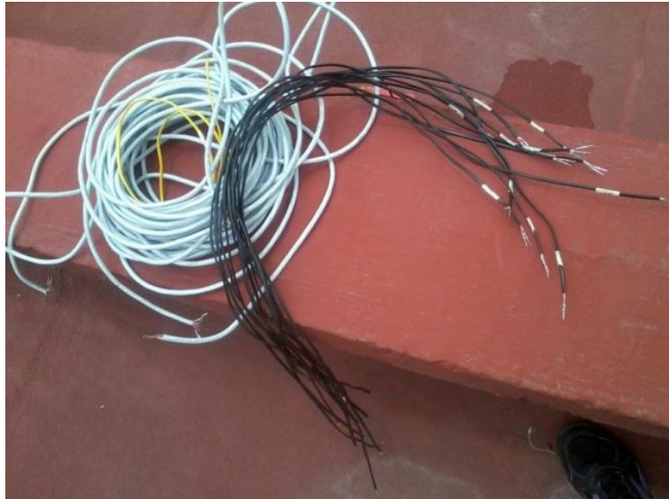
Figura 3.20. Termopares y cables de extensión utilizados en el secador solar
