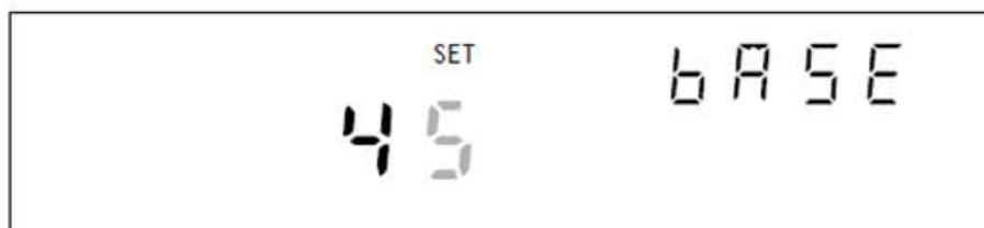
Pantalla de ajuste de los 2 dígitos del Número Base del Canal (ejemplo 45 )
