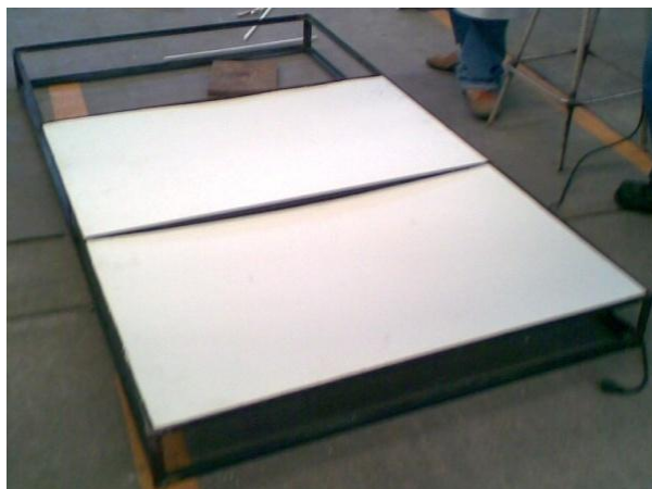
Figura 3.16. Construcción del colector solar
