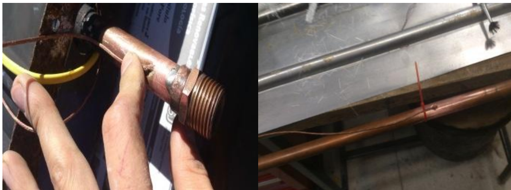
Figura 3.12. Sujeción de los termopares de los calentadores
