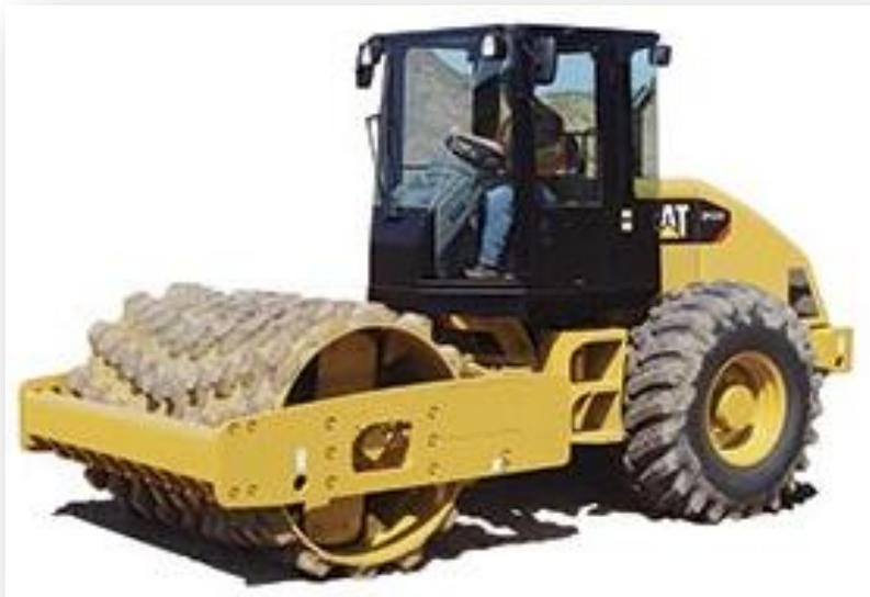
**Img 27.** Compactador tipo “pata de cabra”.
