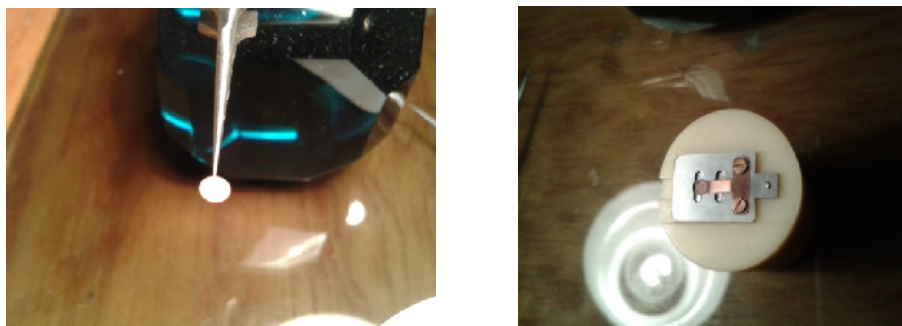
Figura 3.7. a) Imagen izquierda, rejilla de análisis de TEM y b) Imagen derecha, sujetador de rejilla
