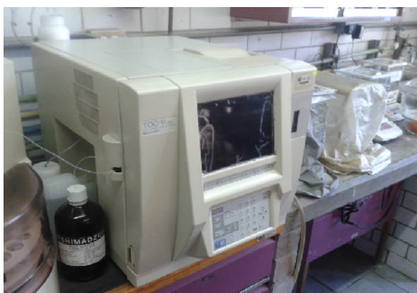
Figura 3.5. Equipo analizador de COT, marca Shimadzu
