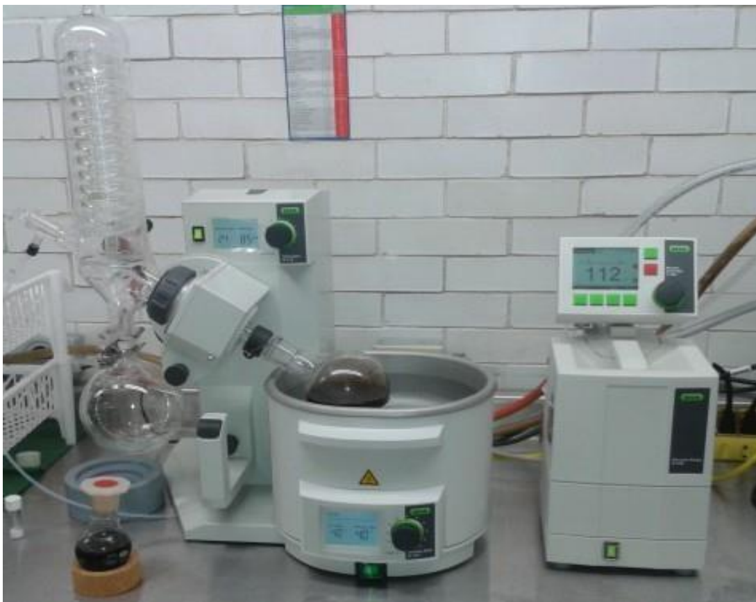
Figura 9. Extracción del Etanol en el Rotavapor R-210 Advanced. (Tomada por el autor).
