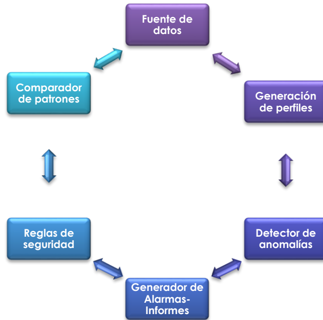
Figura 3.9 - Esquema general de un IDS
