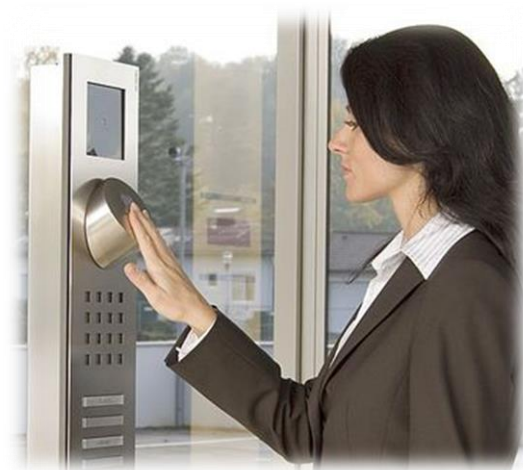
Figura 2.22 - Control de acceso biométrico
