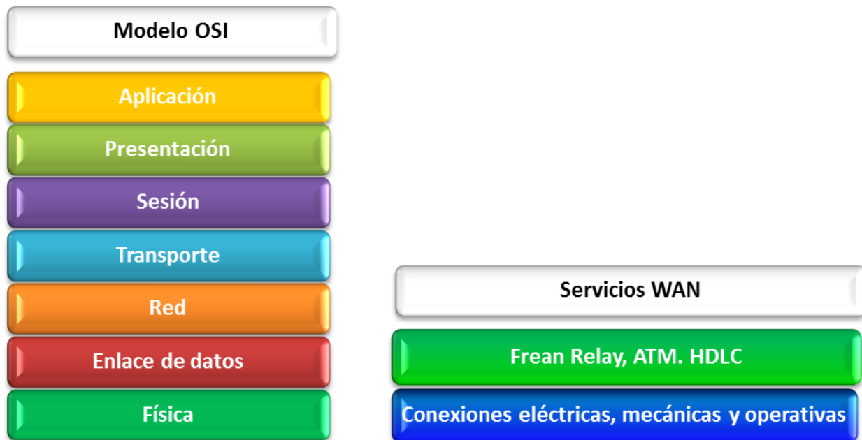
Figura 2.5 - Servicios proporcionados por las redes WAN en el modelo OSI
