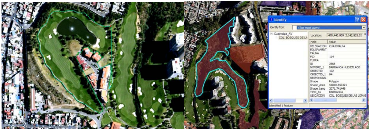
Figura 19. Trazo o digitalización manual de los polígonos sobre el mosaico. A la derecha se muestra la tabla de atributos relacionada con ellos.
