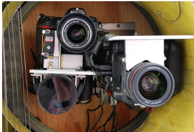
Figura 7. Instalación de varias cámaras digitales en el orificio de un avión adaptado para aerofotografía. En este caso, se colocó una cámara visible independiente (derecha), y un par visible-infrarrojo en una placa común, para garantizar que los dos lentes siempre apunten en la misma dirección, aún cuando las cámaras se desmonten en repetidas ocasiones. Esta placa se instala también en los contenedores externos junto con una articulación esférica multidireccional.
