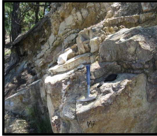
Figura 4.35. Muestra HM-7. El tamaño de la partícula es de arenas gruesas y guijarros, son sub redondeados, es de mala clasificación con un 90% de cuarzo y con una matriz menor a 15%. Se ubica en la localidad de La Carretera (CCC).
