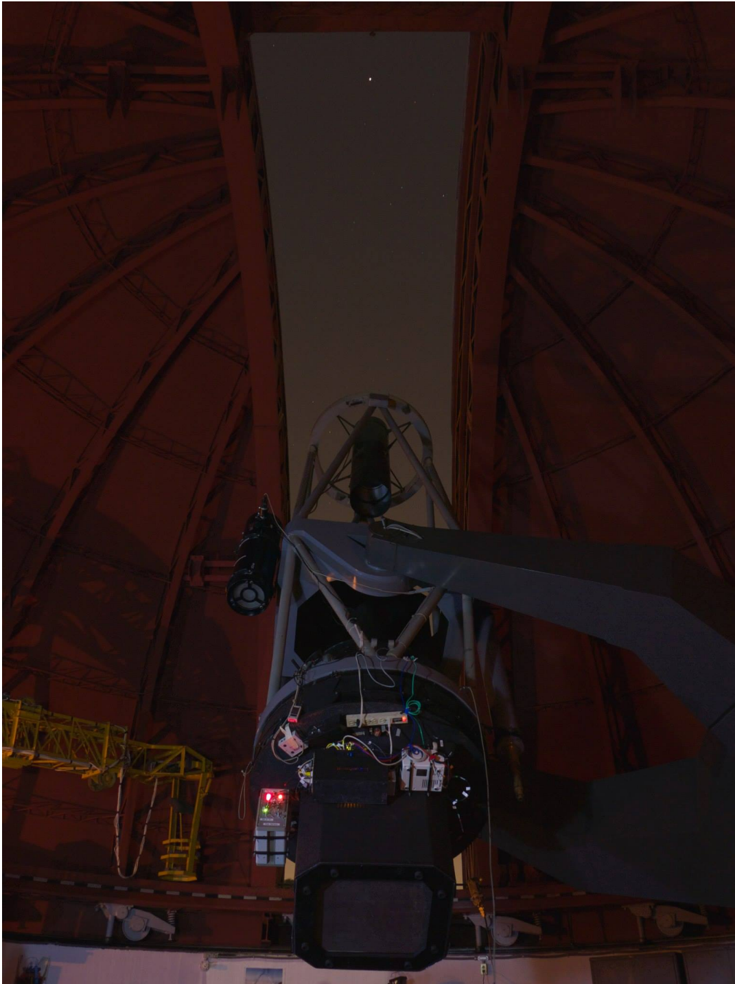
Figura 2.2: Sistema óptico OAXACA colocado en el telescopio de 1 m en el OAN, Tonantzintla, Puebla, observando la estrella Arcturo. (Foto: A. M. Watson)
