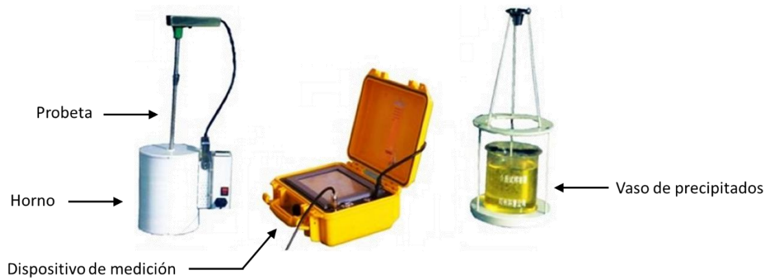
Figura 2.4 Esquema que muestra el equipo experimental GM para evaluar la severidad de enfriamiento de aceites para temple [16].
