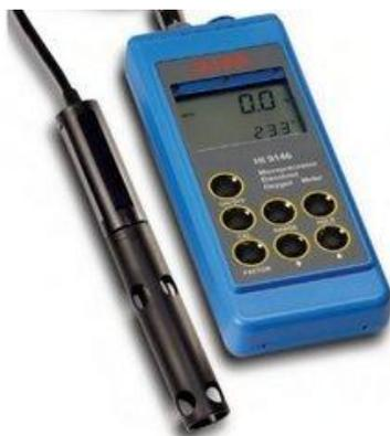
**FIGURA 3.4** Medidor de oxígeno disuelto Hanna (HI9146)
