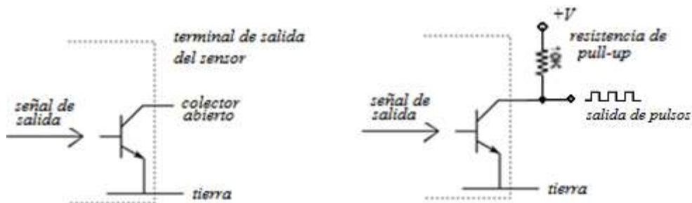
Figura 3.2 Configuración colector abierto.
