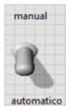
Figura 5.37 Control “manual/automático”, del panel de control.
