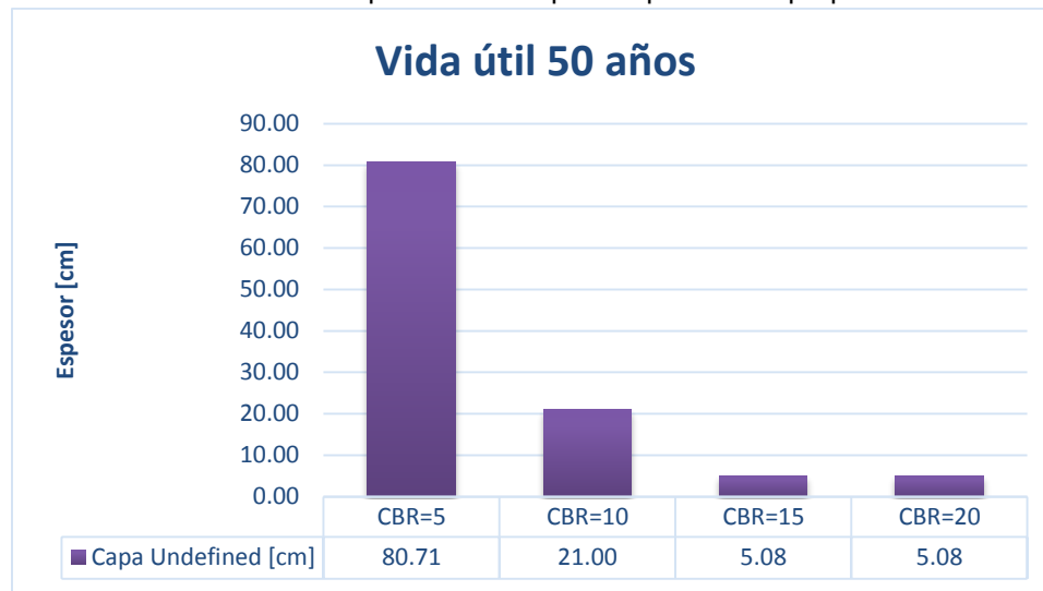
Gráfico 3.10 Espesores de capas en pavimento perpetuo
