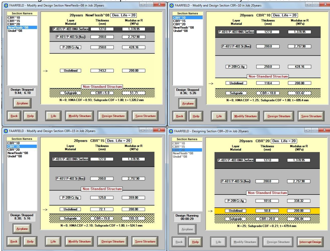
Figura 3.27 Estructura de pavimento con vida útil de 20 años y CBR de 5% a 20%
