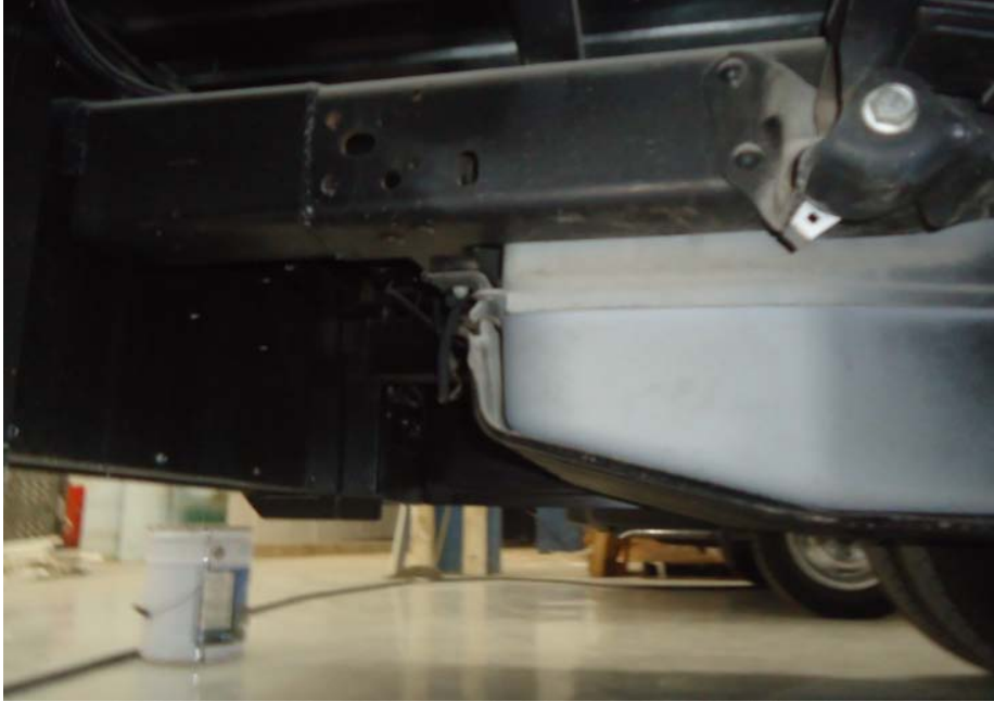
Figura 3.1 Imagen capturada en la parte interior trasera de una ambulancia que muestra el alargamiento de chasis como una de las modificaciones realizadas
