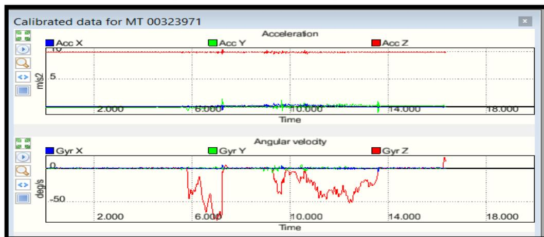
**Ilustración 51. Visualización de la rotación respecto al eje z para aceleración, velocidad angular y orientación magnética**
