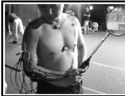
Ilustración 3. Método experimental para medir ángulos de Euler para brazo (Koon, Wangdo, & John, 2005)
