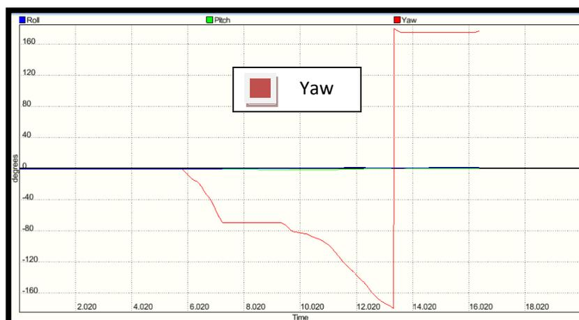
Ilustración 52. Gráfica de la rotación respecto al eje Z para los ángulos de Euler Roll, Pitch y Yaw.
