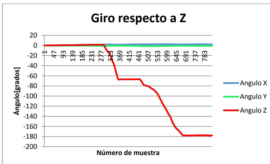
Ilustración 53. Gráfica de la rotación de un acelerómetro alrededor del eje z.
