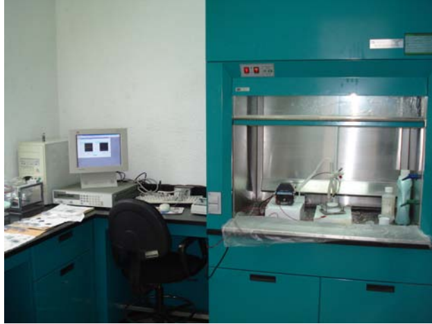
Figura 1.21. Lugar donde se realiza la anodización electroquímica. Se observa la computadora con la que se programa la fuente de corriente, localizada debajo del monitor y la campana de extracción que se utiliza para evitar la acumulación de vapor de HF, dentro de la cual se encuentra la celda electroquímica.
