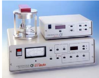
Figura 1.18. Imagen del equipo de sputtering al cual se le acopla un monitor de espesor MTM-10.
