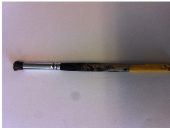
Fig. 2.12 Pincel utilizado para obtener el patrón aleatorio sobre las probetas.
