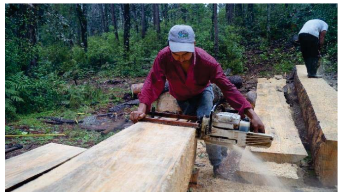
52. Trabajador aserrando en el sitio donde se derribó el árbol
