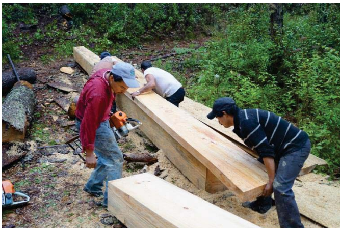
55. Vigas de madera obtenidas en el proceso de aserrado en el rancho
