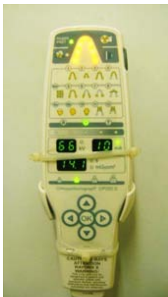
Figura 3-16. Control y disparador del ortopantomógrafo INSTRUMENTARIUM ORTHOPANTOMOGRAPH OP200 D. El panel incluye valores de exposición y tipos de corte. El disparador es el botón observado en la esquina lateral superior derecha.
