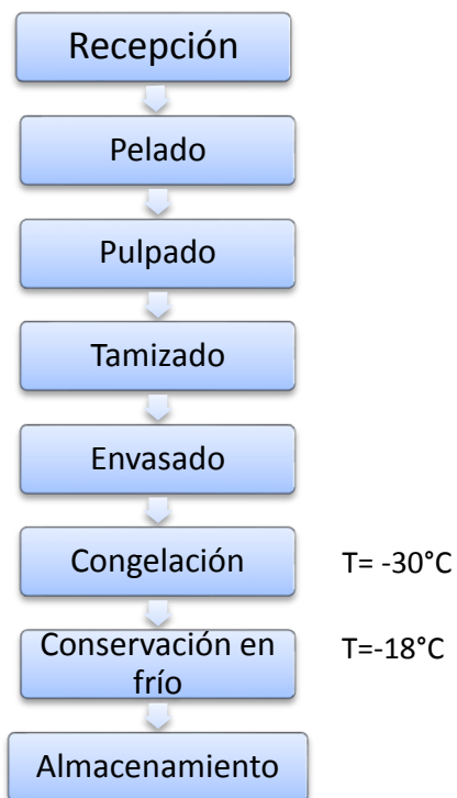
Figura 50. Diagrama de flujo para la elaboración de pulpas congeladas de tuna.
