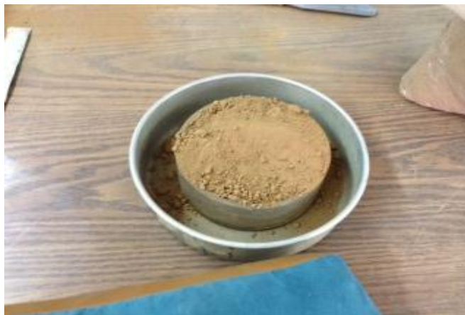
Fig. 5.8.- Prueba de Atterberg.
