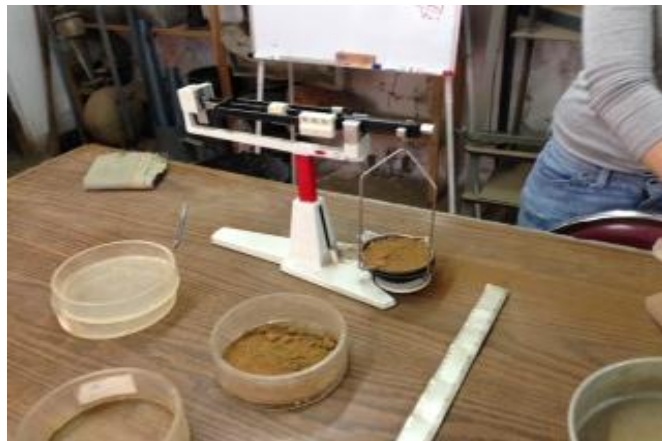
Fig. 5.7.- Prueba de granulometría y límites de Atterberg.
