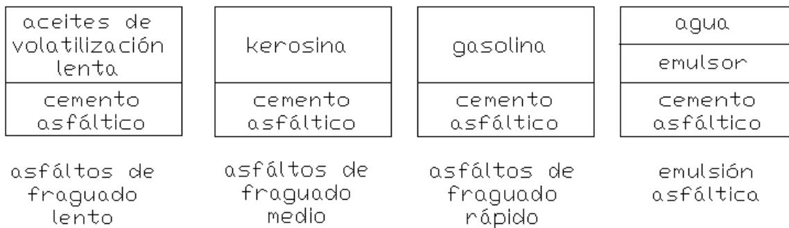
Fig. 2.4.- Tipos de productos asfálticos líquidos.
