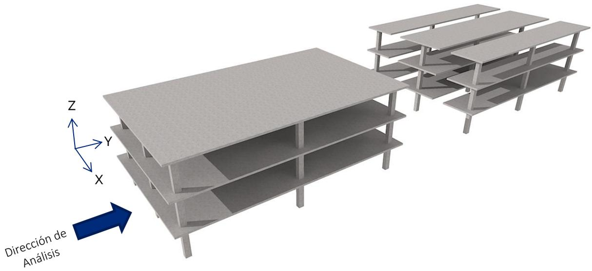
Figura II-5 Marcos equivalentes de la estructura en dirección de análisis Y
