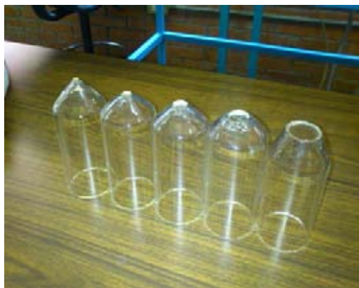
Figura 9. Imagen de tolvas utilizadas en prueba de fluidez de materias primas.
