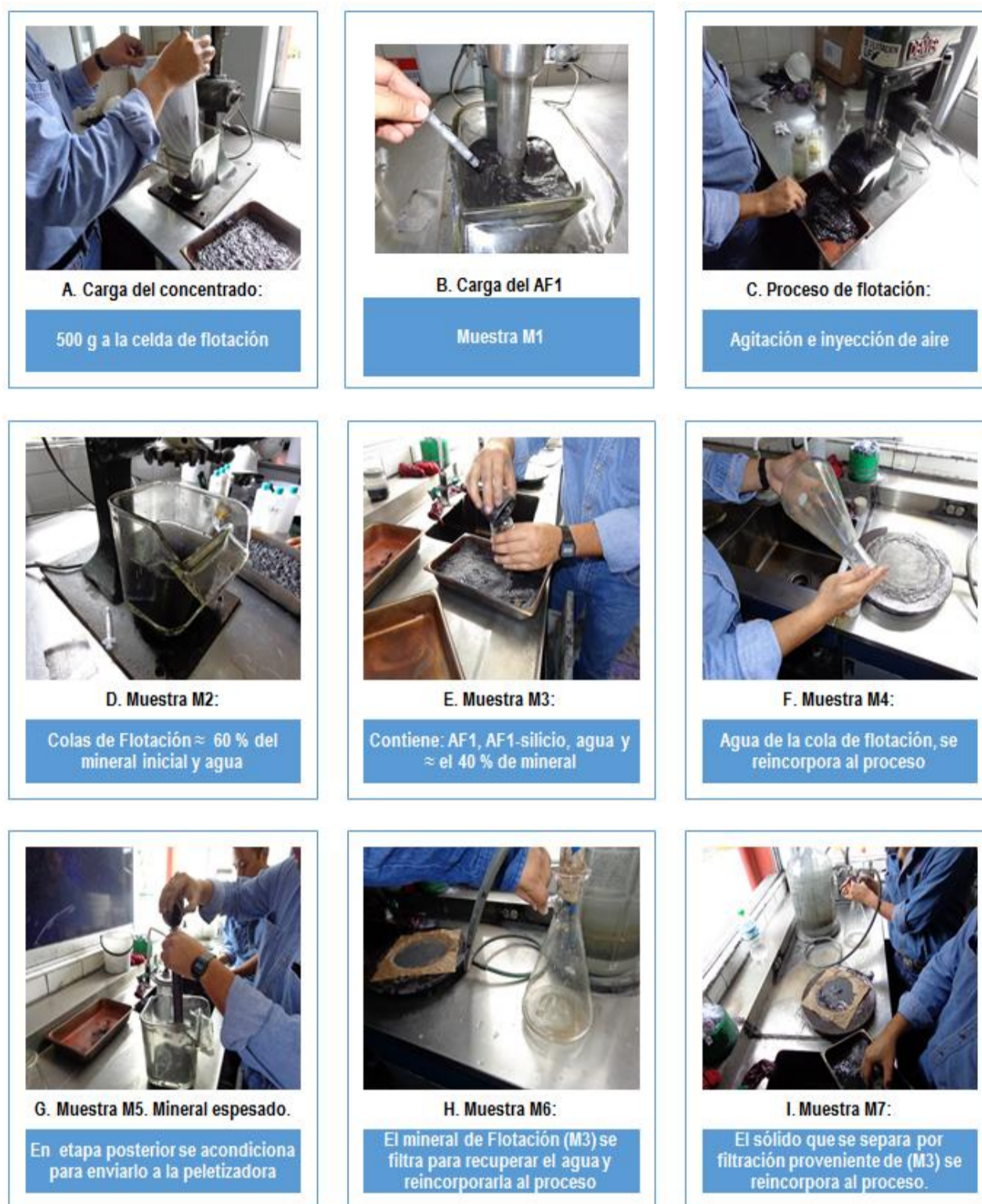
FIGURA 16.MEMORIA FOTOGRÁFICA DEL PROCESO DE FLOTACIÓN
