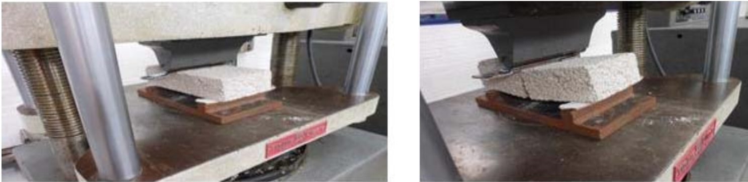
Fotografía 13. - Prueba de flexión en tabicón tradicional. Carga soportada fue de 100 kg Fuente: Elaboración propia
