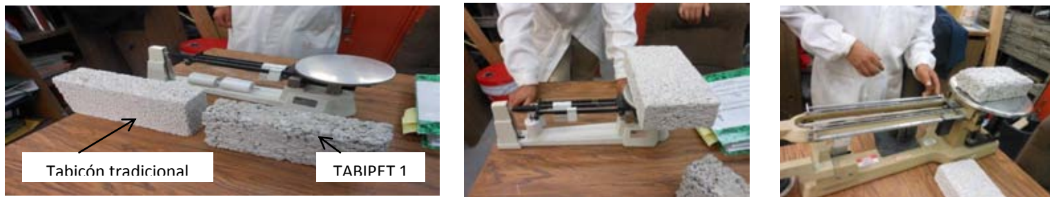
Fotografía 11. - Diferencias físicas y pesaje de ambos bloques Tabicón tradicional 1.462.5 Kg. TABIPET 3.139 kg. Fuente: Elaboración propia
