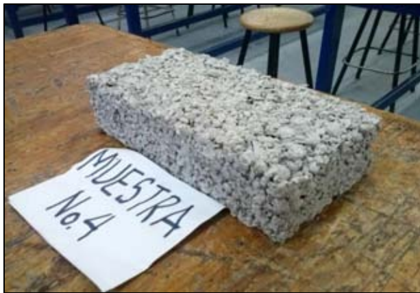
Fotografía 10. - Muestra cuatro descimbrada Fuente: Elaboración propia
