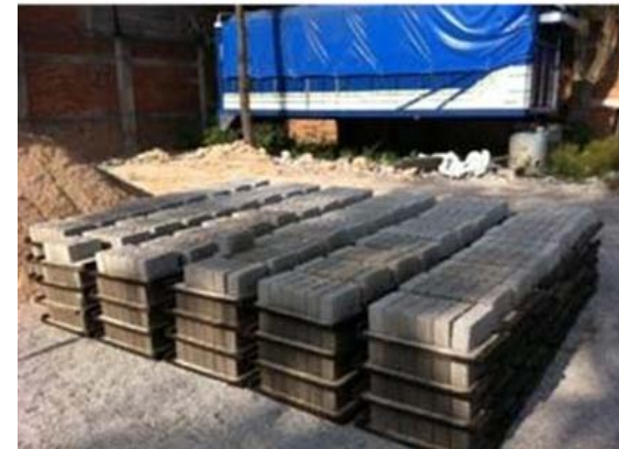
Figura 74. - secado del tabicón Fuente: http://www.materialesdeconstruccion.com.mx/materiales-tabicon.php
