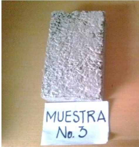
Fotografía 25. - TABIPET 3 Concreto ligero Fuente: Elaboración propia
