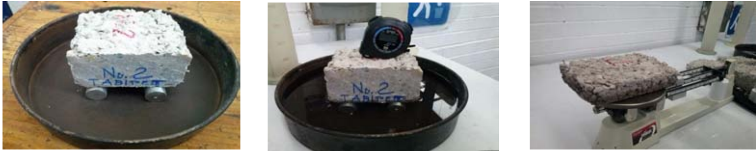
Fotografía 21. - Proceso para obtener el peso de las muestras en estado de absorción de agua durante 10 minutos Fuente: Elaboración propia
