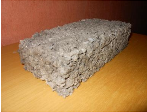
Fotografía 23. - TABIPET 1 (concreto) Fuente: Elaboración propia
