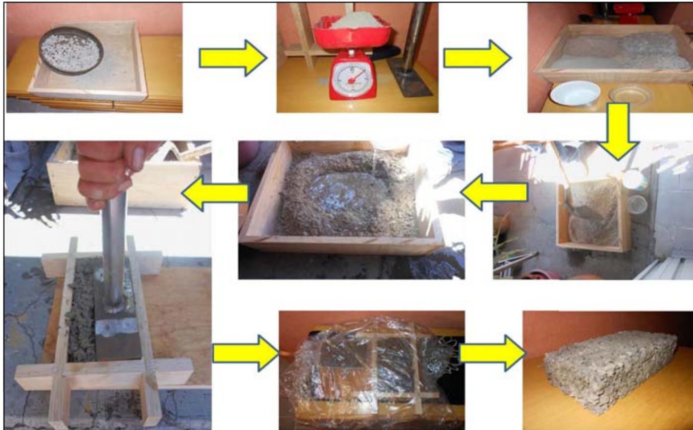
Fotografía 4. - Proceso de elaboración de las muestras de TABIPET Cribado, pesado, mezcla, colado, curado y descimbrado. Fuente: Elaboración propia
