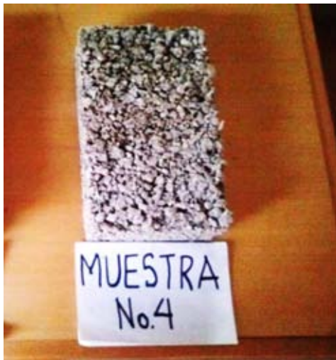
Fotografía 26. - TABIPET 4 Concreto ligero Fuente: Elaboración propia
