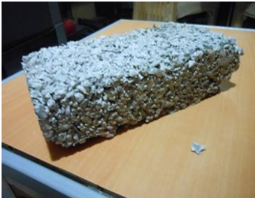
Fotografía 24. - TABIPET 2 (concreto ligero) Fuente: Elaboración propia
