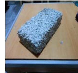
Fotografía 6. - Segunda muestra TABIPET 2 y materiales utilizados Fuente: Elaboración propia
