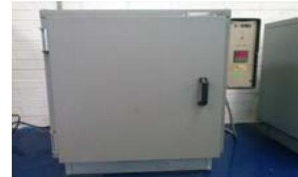
Fotografía 16. - Fotografía 18 Secado de las muestras en Horno de convección marca CONTROLS Fuente: Elaboración propia
