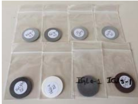
Figura 3.5 Conjunto de las 8 muestras IGL's utilizadas en la calibración del equipo X-Calibur.
