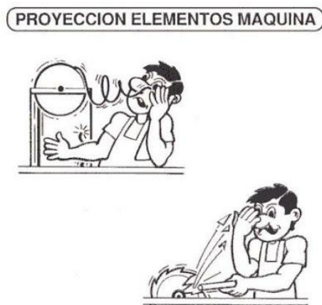
Figura 9. Proyección de elementos por falta de seguridad
