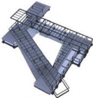
Vigas del 1er nivel
