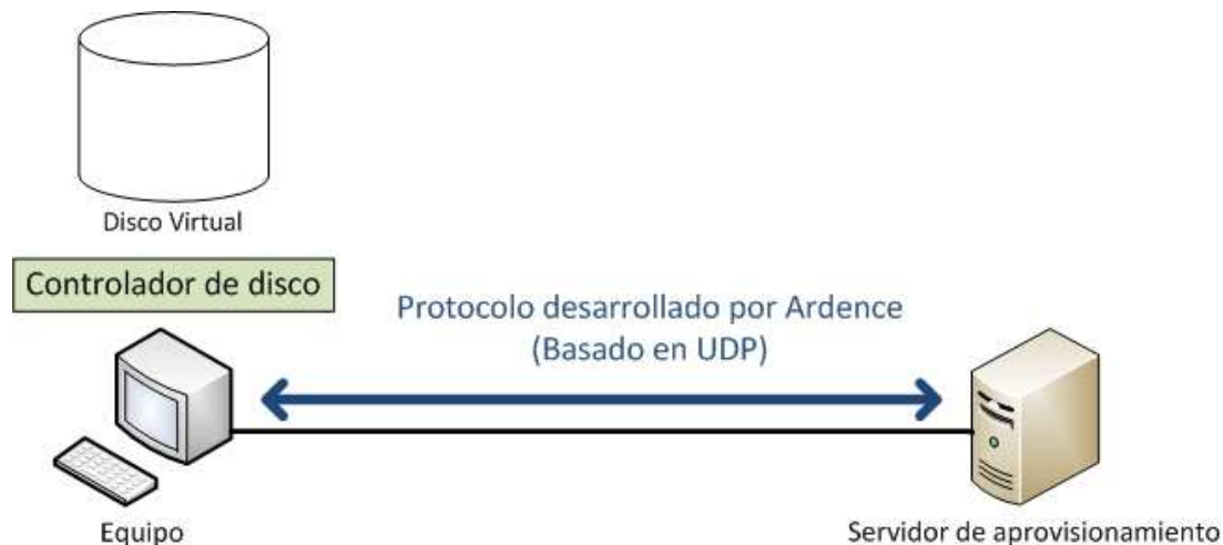
Figura 3.10: Funcionamiento técnico del streaming de discos virtuales.
