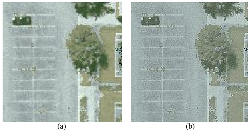
Figura 4.15: Laplaciano multiespectral (LMM) sobre una imagen multiespectral sintética. (a) Imagen original, (b) Imagen realzada con la ecuación (4-19).
