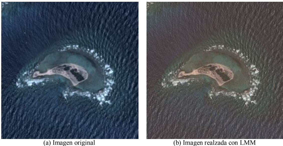
Figura 4.19: Laplaciano multispectral (LMM) sobre una imagen multispectral de satélite. (a) Imagen original, (b) Imagen realzada. Los realces aplicados a las imágenes son únicamente con fines de mejorar la visualización de las mismas 4 .
