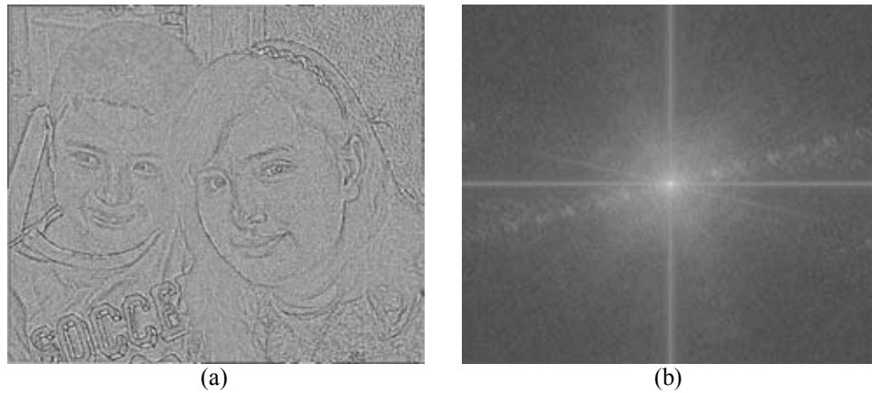
Figura 4.6: Realce de bordes en el dominio de la frecuencia. (a) Realce de bordes por medio del operador Laplaciano vía transformada de Fourier, aplicando posteriormente una equalización del histograma para evidenciar los bordes realzados (b) Transformada de Fourier de la imagen original.
