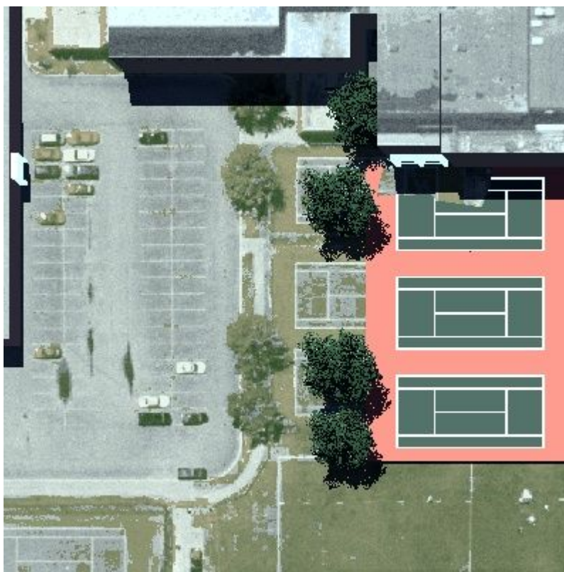
Figura 5.19: Compuesto en falso color de una imagen multispectral sintética en el rango visible, donde [RGB] = [Banda1, Banda2, Banda3].
