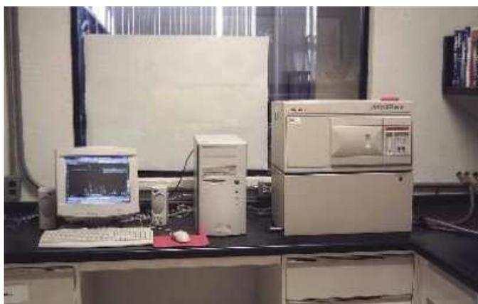
*Figura 11. Equipo de difracción de Rayos X.*
