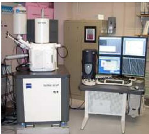
*Figura 12. Microscopio Electrónico de Barrido de Emisión de Campo*
