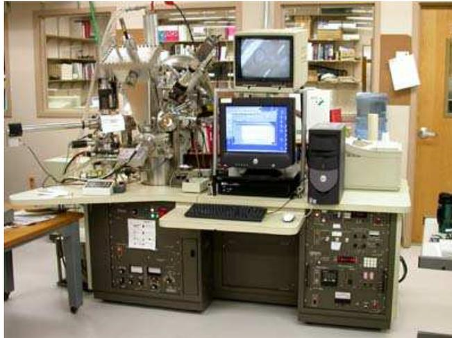
*Figura 15. Equipo de espectroscopía fotoelectrónica de rayos X (XPS).*
