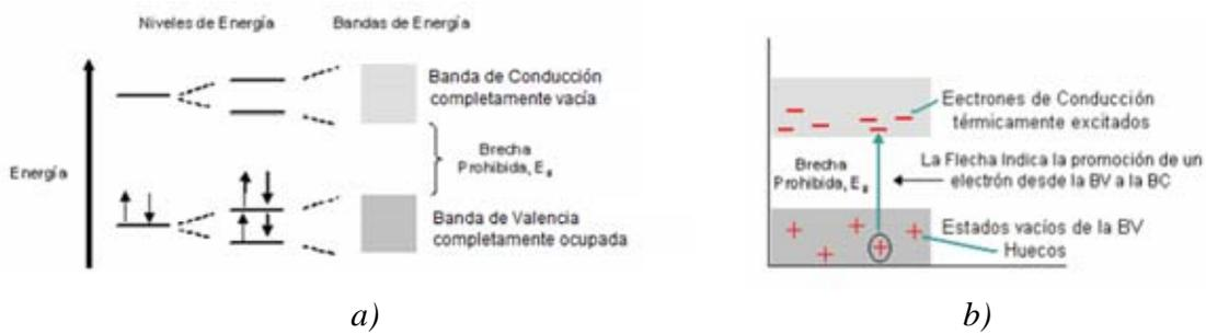
Figura 2. Bandas de energía en sólidos; a) 0 °K ; b) 300°K [11].
