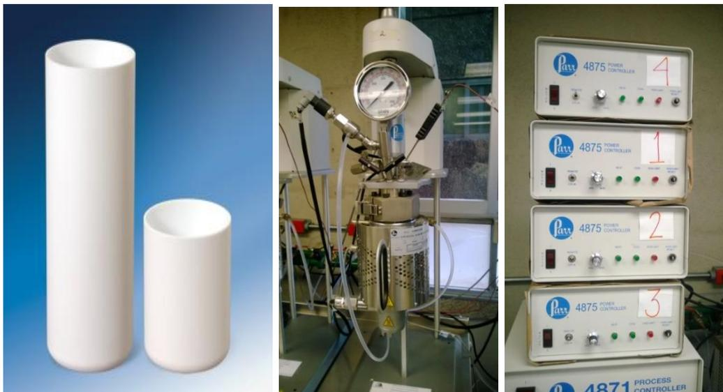
*Figura 7. Vaso de PTFE utilizado y reactor Parr de acero inoxidable con sistema controlador remoto (Parr, 2013).*
