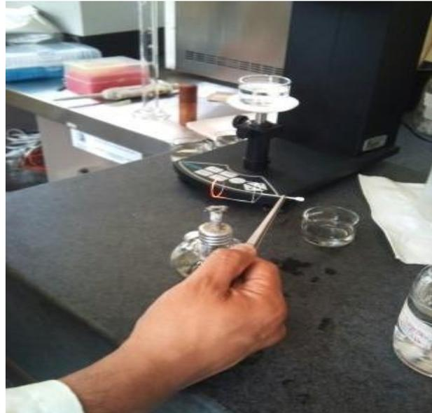
**Foto 45:** Método de Du Noüy o del anillo, para determinar la tensión superficial de líquidos.
