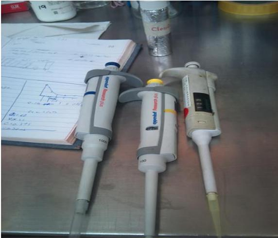
**Foto 42:** Dispensadores. Extensión natural del brazo del investigador experimental. Dosifican cantidades milimétricas exactas.
