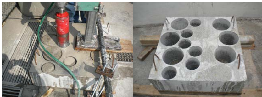
Figura 3.16 Extracción de testigos y placa al término de la extracción
