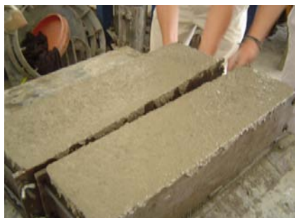
Figura 3.15 Moldeado y vibrado de especímenes
