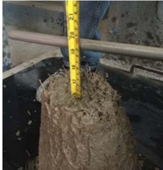
Figura 3.14 Prueba de revenimiento
