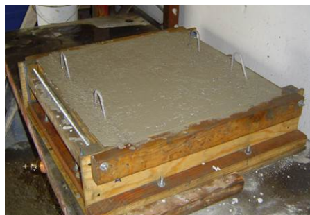
Figura 3.15 Moldeado y vibrado de especímenes
