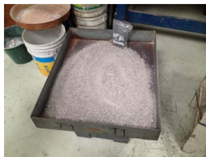
Figura 3.22 Probeta al término de la extracción de fibras
