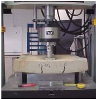
Figura 1.14 Configuración del panel cuadrado (EFNARC, 1996)
