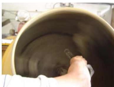
Figura 3.12 Incorporación de aditivo Pozzolith 322 N
