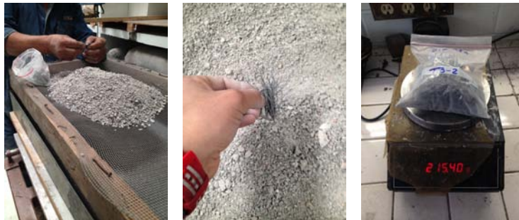
Figura 3.21 Procedimiento de extracción y pesado de fibras
