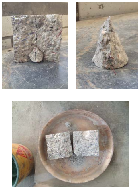
Figura 3.19 Detalle de conteo de fibras en caras y cono de rotura
