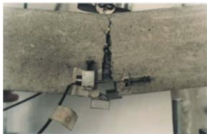
Figura 1.12 Instrumentación de ensayo de flexión en tres puntos (EN 14651)
