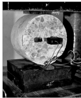
Figura 1.8 Ensayo Brasileño modificado (Carmona et al. , 1998)
