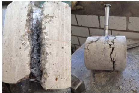
Figura 3.18 Detalle de fisuración y procedimiento de separación
