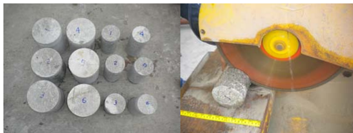
Figura 3.17 Testigos extraídos y procedimiento de corte
