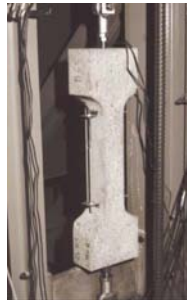
Figura 1.4 Configuración del ensayo con espécimen en forma de hueso de perro (Reinhardt, 1998)
