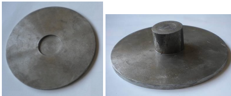
Figura 3.7 Disco de apoyo para probetas de 150 mm de diámetro
